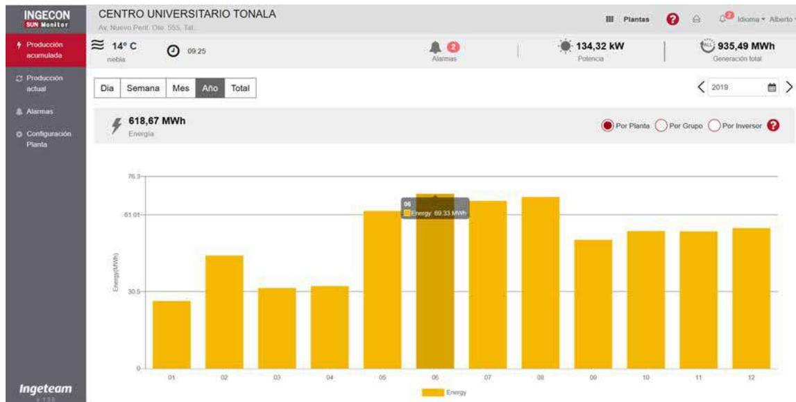
Figura 14. Generación eléctrica del huerto solar fotovoltaico, 2019.
